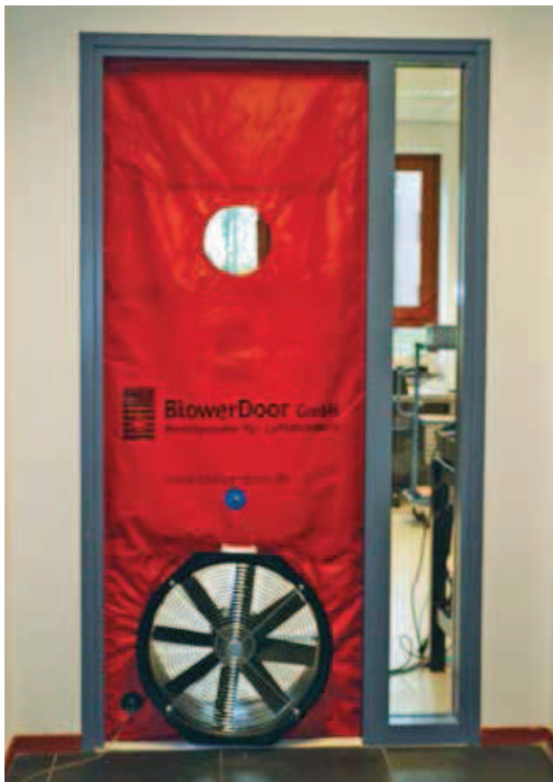
Meting blowerdoor luchtdichtheid van gebouwen op locatie.
