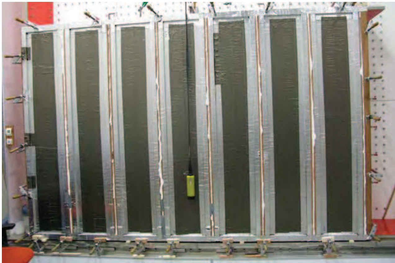
Meting luchtdichtheid materialen voor luchtdichte afwerking van gebouwen.
